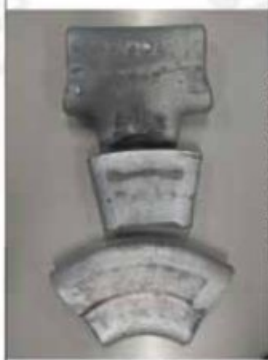
照片 E：測試後（抗壓試驗）
